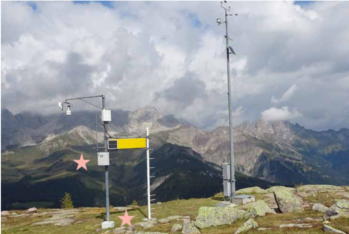
Fig. 2 - Installazione delle due sonde Finapp sulla stazione ARPAV di Cima Pradazzo (M. Valt).
