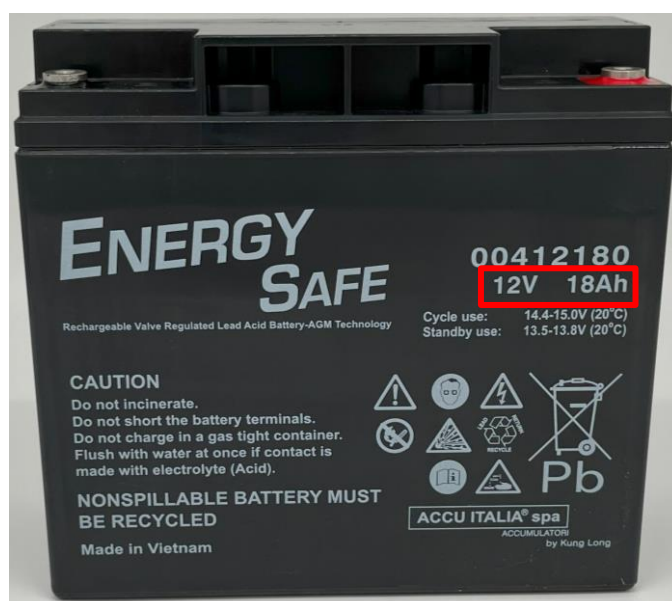
Fig.34-Esempio di batteria utilizzata per alimentare la sonda. Nel riquadro rosso sono indicati la tensione (12V) e la capacità (18Ah).
